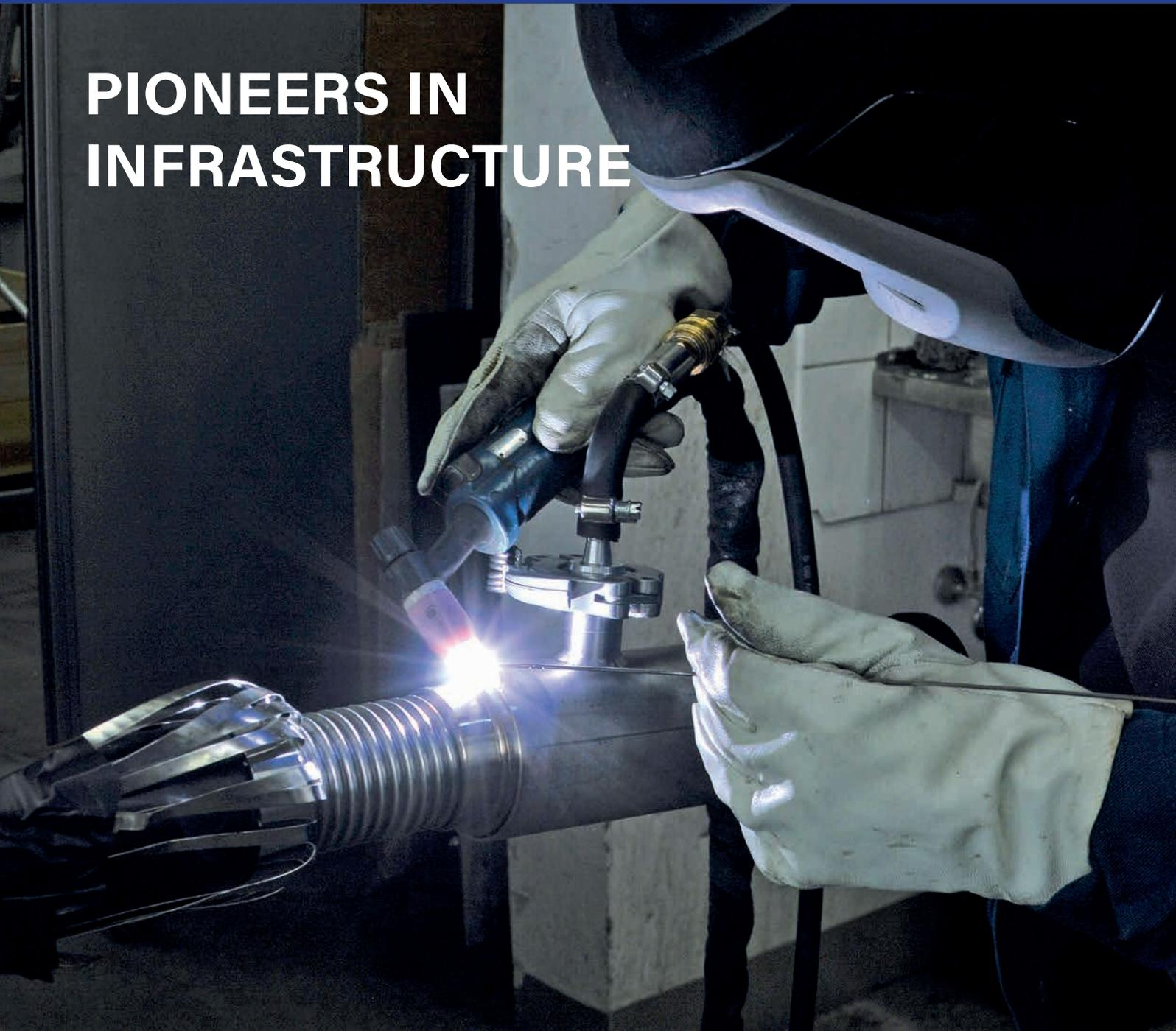
FLEXWELL® CRYO PIPE – Rohrsystem für kryogene Gase
