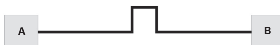
Figure 4 Tracé droit entre deux points avec absorption de la dilatation par coude en U à l'intérieur du tracé.
