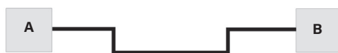
Figure 3 Tracé rectiligne entre deux points avec absorption de la dilatation par coude en Z à l'intérieur du tracé.
