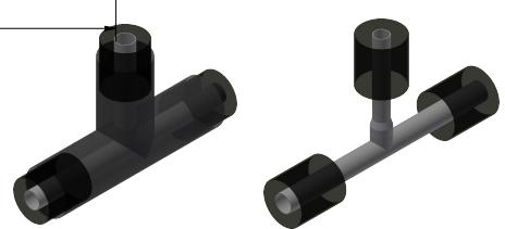
Sind am Abgang Armaturen? Nein Ja Typ: voller Durchgang red. Durchgang
