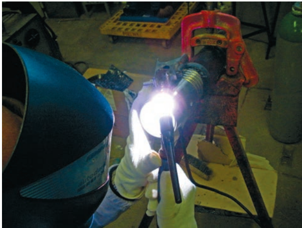
WIG-Schweißen einer Anschlussverbindung
