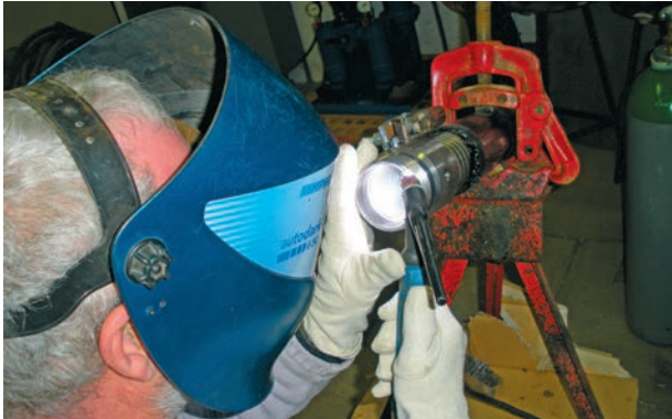
Schweißen einer Anschluss- verbindung mit dem WIG-Schweißverfahren
