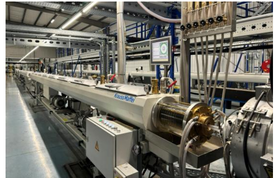
Auf zahlreichen Hochleistungsextrudern fertigt MAGNUM 5-schichtige Kunststoff-Heizungsrohre aus PE-RT für OEM-Kunden © Magnum
