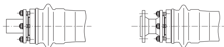
Fig. 2: tipi d'esecuzione del raccordo di giunzione
